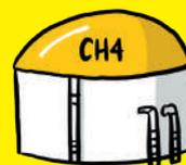
Les déchets alimentaires sont stockés dans une unité fermée. En l'absence d'oxygène, la réaction de décomposition de ces déchets produit du méthane qualifié de « biogaz ». Une fois traité, il rejoint le réseau de gaz naturel et pourra, par exemple, alimenter les camions de collecte des déchets.
